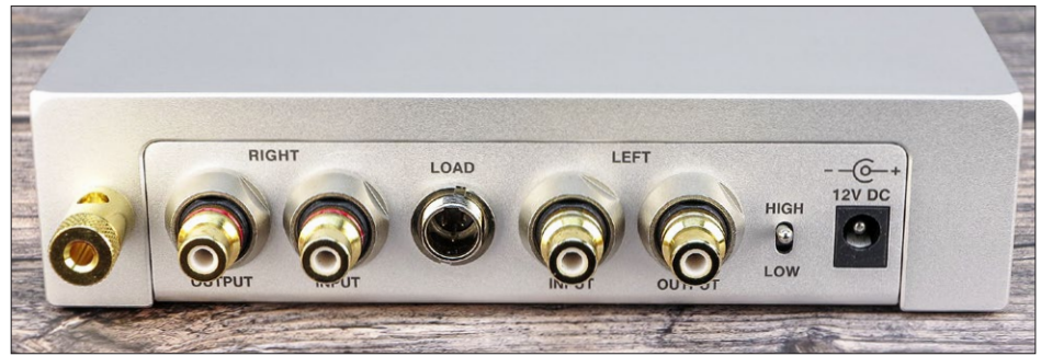
Die Rückseite bietet vier fest mit dem soliden Gehäuse verschraubte Cinch-Buchsen, eine Masseklemme, Anschlüsse für Netzteil und Anpasstecker sowie den Umschalter für den Verstärkungsfaktor.
