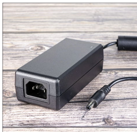
Das externe, störrarme 12-Volt-Schaltnetzteil wurde in Hörsitzungen nach Klang ausgesucht.
