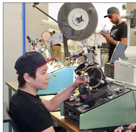
Nur speziell geschultes Nagra-Personal darf die hochoffenen Trafo-Übertrager wickeln.
