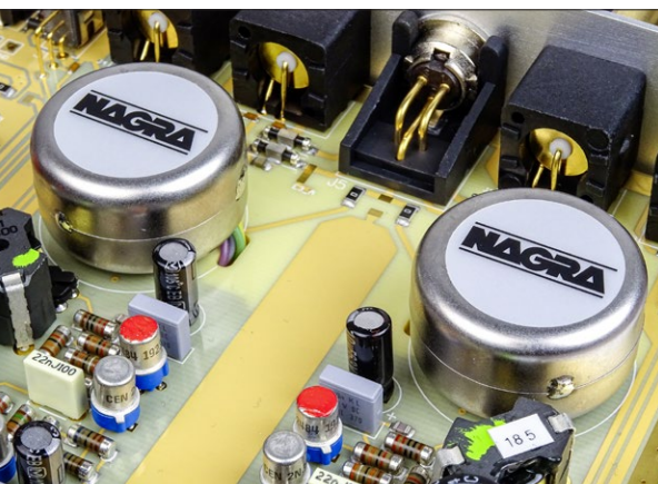
Die gekapselten Übertrager sitzen am Anfang des Signalwegs und sind eine Nagra-Spezialität.
