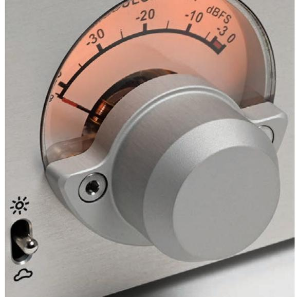
**Gros plan sur le module à la luminosité réglable. Le commutateur barré de rouge évoque le pays d'origine. Un préchauffage d'environ 15 secondes est appliqué à l'allumage, pour la mise en chauffe des composants.**
