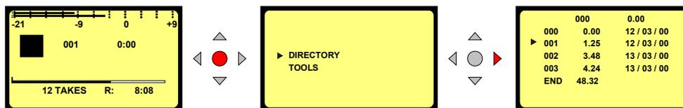
Les touches "Flèches" (9, 11, 10, 12) permettent de se déplacer verticalement et horizontalement dans le Catalogue afin de sélectionner les prises et obtenir les renseignements relatifs à chaque prise.
