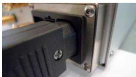
Placez les sélecteurs des faces avant et arrière sur la position **OFF**. Connectez la prise IEC dans son logement.
