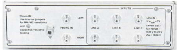
左側面の入力端子. 内部で負荷抵抗やレベルを設定できる
