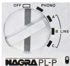
電源スイッチを兼ねたセレクター。OFFポジション以外では赤いマークが見え、電源が入っていることを示す
