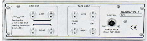
右側面の出力端子とテープ端子. 右端は電源入力端子
