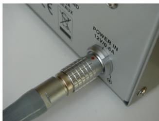
La prise LEMO est marquée d'un point rouge qui doit être placé vers le haut pour s'insérer correctement dans le connecteur d'alimentation.
