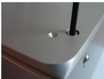
Retirez les quatre vis du panneau supérieur du VPS avec la clé fournie.
