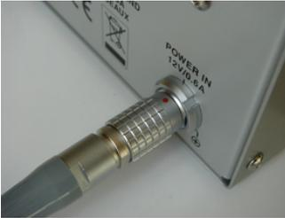
Der LEMO Stecker besitzt einen roten Punkt, der beim Einstecken in den Stromanschluss nach oben zeigen sollte.
