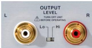
Der Nagra VPS bietet zwei Ausgangsspannungen: 300 mV (Lo) und 2 V (Hi), umschaltbar auf der Gehäuserückseite (siehe Bild).
