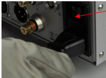
Placer le coupe-circuit sur la position **OFF** (ou OFF, éteint). Insérer le cordon IEC.
