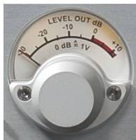
Le modulomètre Nagra est l'outil de référence de l'ingénieur du son. Il équipe tous les enregistreurs Nagra depuis 1952 et la sortie du Nagra II. C'est un instrument de précision qui permettait d'afficher le niveau du signal enregistré sur la bande. Dans le cas du MELODY, le modulomètre indique le niveau de sortie. L'indication 0 dB correspond à un signal de 1 V rms en sortie.
