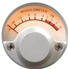
Le CDC est équipé du Modulomètre stéréo Nagra. Cet instrument de mesure, identique à celui de l'enregistreur professionnel Nagra V, indique le niveau du signal enregistré sur le CD.
