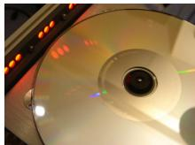
Le tiroir du CDC est équipé d'un système d'éclairage destiné à faciliter le positionnement du disque par faible luminosité.
