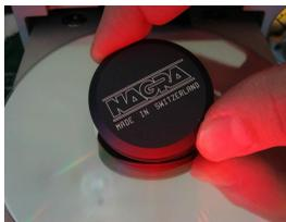
Le CDC est pourvu d'un capteur de présence du palet-presseur (appelé « Clamp » en anglais). Si vous oubliez ce dernier le message "NO CLAMP" apparaît sur l'afficheur.
