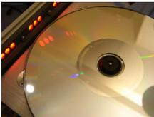
Die CD-Lade des CDC besitzt ein Beleuchtungssystem um das Einlegen von CDs bei Dunkelheit zu erleichtern.
