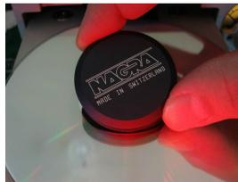
Der CDC ist mit einem Klammererkennungssystem ausgestattet. Wenn Sie die Klammer vergessen, erscheint die Meldung "NO CLAMP" auf dem Display.
