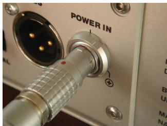
Der LEMO Stecker besitzt einen roten Punkt, der, beim Einstecken in den Stromanschluss, nach oben zeigen sollte.
