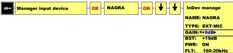
Pour changer le gain d'entrée, sélectionner le nom de l'entrée choisie et presser "OK" puis presser deux fois la touche ▼ afin de placer la position "**GAIN**" en surbrillance.
