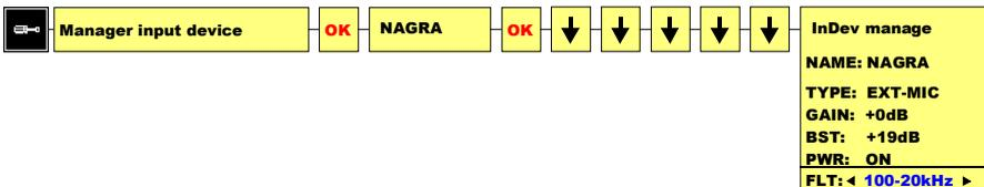
Un filtre peut être sélectionné dans le cas d'une entrée de type "EXT-MIC". Pour le configurer, sélectionner le nom correspondant à l'entrée choisie et presser "OK" puis presser la touche ▼ cinq fois afin de placer la position "FLT" en surbrillance.
