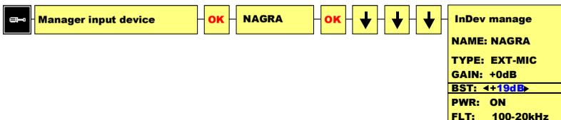
Un gain additionnel peut être ajouté au gain configuré précédemment, seulement dans le cas d'une entrée microphone externe "**EXT-MIC**". Pour modifier la valeur du gain additionnel, sélectionner le nom correspondant à l'entrée choisie et presser "OK" puis presser la touche "DOWN" trois fois afin de placer la position "**BST**" en surbrillance.
