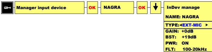
Ce sous-menu permet de sélectionner l'entrée qui sera utilisée pour l'enregistrement. Pour changer le type d'entrée, se placer sur "**Gestion des entrées**" et presser "OK" puis la touche ▼ afin de placer la position "**TYPE**" en surbrillance.
