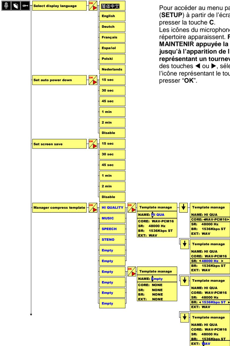
Pour accéder au menu paramétrage (**SETUP**) à partir de l'écran principal, presser la touche **C**. Les icônes du microphone et du répertoire apparaissent. **PRESSER ET MAINTENIR appuyée la touche ► jusqu'à l'apparition de l'icône représentant un tournevis**. A l'aide des touches ◀ ou ▶, sélectionner l'icône représentant le tournevis puis presser "OK".
