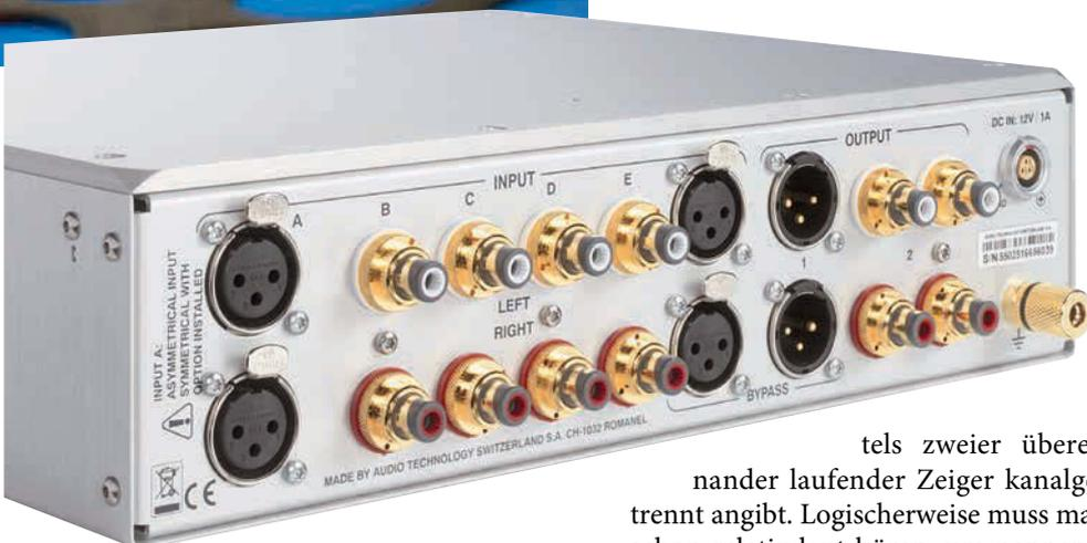
**Insgesamt fünf Eingänge sind vorhanden. Auch der XLR-Input ist intern unsymmetrisch ausgeführt und kann mit einem optionalen Übertrager-Board (um 1450 Euro) symmetriert werden. Der „Bypass“-Eingang umgeht die Lautstärke-Regelung. Extra Masseklemme für die Erdung**
