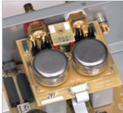
Der VPS wird mit den Jumpers hinter den Übertragern konfiguriert
