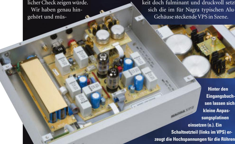
Hinter den Eingangsbuchsen lassen sich kleine Anpassungsplatinen einsetzen (o.). Ein Schaltnetzteil (links im VPS) erzeugt die Hochspannungen für die Röhren
