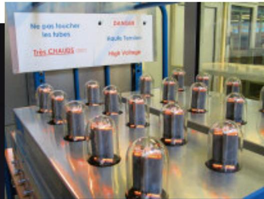
„Von 100 Röhren sind oft nur zehn für unsere Zwecke geeignet“, sagt Nagra. Um diese zehn zu finden, müssen die 845-Leistungsröhren unter anderem einen Einbrenntest bestehen
