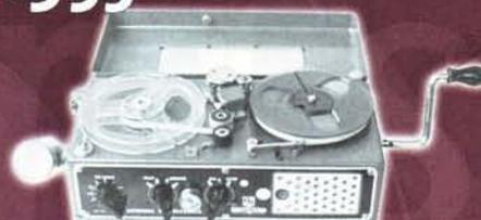
**Nagra II:** Ein Thorens-Motor übernimmt den Antrieb – die nötige Energie muss erst einmal zusammengekurbelt werden.
