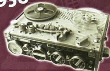
**Nagra III:** Ein Standard für Ton-Techniker in aller Welt – die erste portable Bandmaschine, die sogar Studioeinbauten übertraf.
