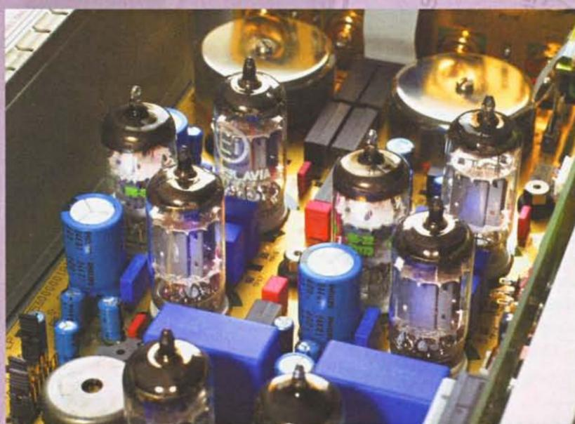
Aufwändiges Verfahren: Nagra lässt die Röhren (hier in der Vorstufe PL-P) bis zu 400 Messungen durchlaufen, um eine ideale Auswahl treffen zu können.
