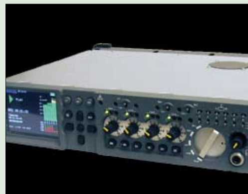
„Nagra VI“ zeichnet bis zu sechs Kanäle gleichzeitig im HD-Format auf.
