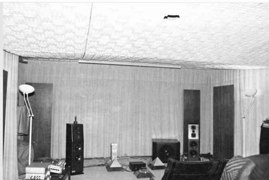
Nagra的「工作」音響室，從圖中可以看出天花板採用吸音泡棉，喇叭後面與側牆各擺二片木板來反射聲波，其他地方則掛著黃色布幔。由於是要分辨細微聲音差異，為了減少牆壁反射音的干擾，所以設計成幾乎全吸音。Matthieu告訴我，他們正著手在設計一間聆聽音樂用的音響室，屆時跟這間音響室會有很大的不同。
