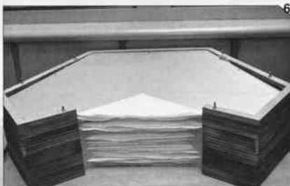
3 這是金字塔後級的「頂蓋」。每一個頂蓋完成之後都要以氣泡紙保護，以免刮傷。只要有一點刮傷，這件產品就不能賣給客戶了，這是瑞士對品質的要求。
