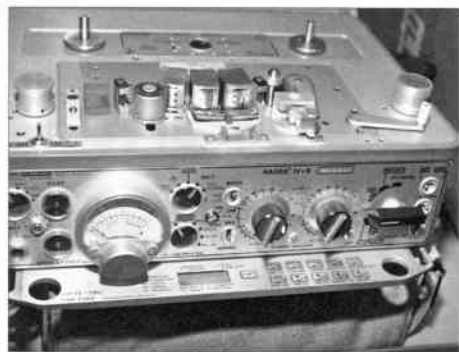
上：這是扯出控制盤的Nagra IV-S，控制盤上的按鍵已經是觸控的，質感很好。
