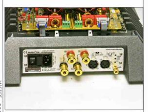
σταθεροποιημένων τροφοδοτικών τα κυκλώματα ελέγχου-προστασίας του ενισχυτή και τα buffer που υπάρχουν στην είσοδό του.
