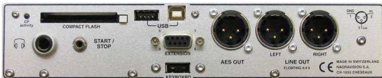
Panneau latéral droit équipé du second port USB hôte "Keyboard"
